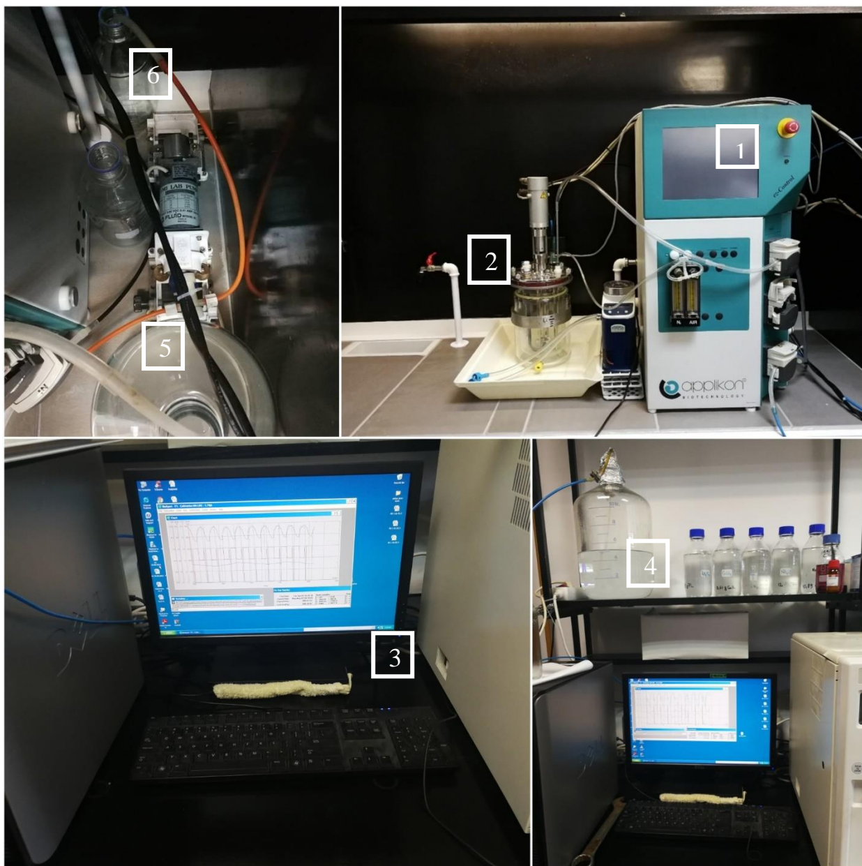
Slika 6. Laboratorijski SBR s kontrolno-upravljačkom jedinicom
