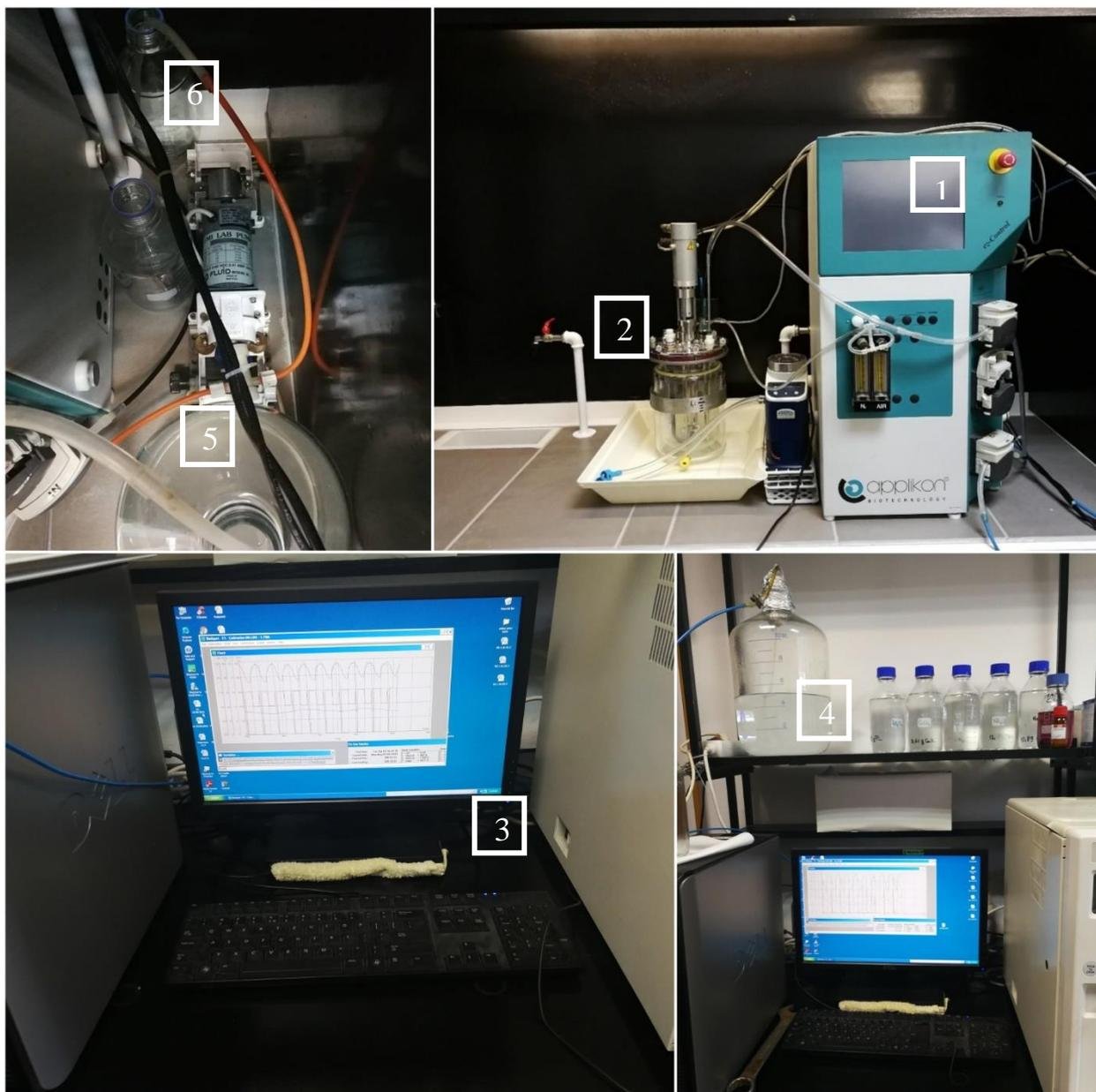
**Slika 6. Laboratorijski SBR s kontrolno-upravljačkom jedinicom**
