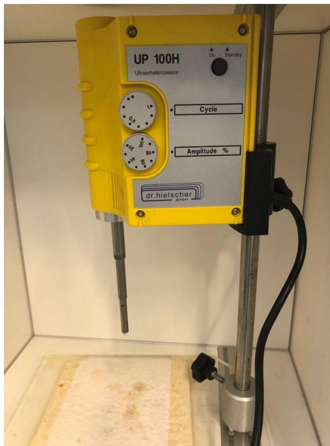
**Slika 5.** Ultrazvučni procesor UP 100 H (Hielscher, Njemačka)
