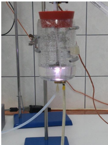
Slika 2. Plazma generirana u mjehurićima argona u uzorku Listeria innocua
