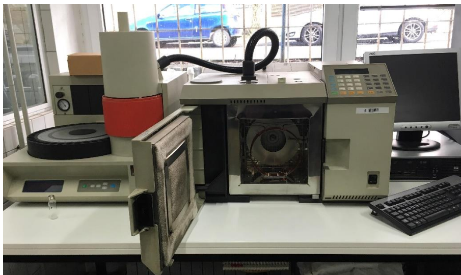
Slika 4. Plinski kromatogram „Perkin Elmer Autosystem XL-GC“ (Perkin Elmer, SAD) uz pripadajući sustav za uzorkovanje „Perkin Elmer Headspace Sampler 40XL“ (Perkin Elmer, SAD)
