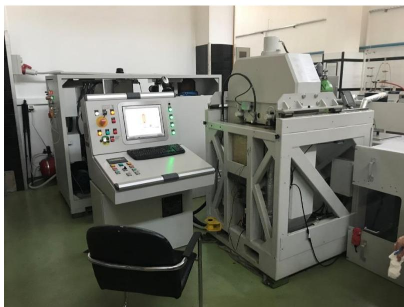
Slika 6. Uredaj za tretman visokim hidrostatskim tlakom (HHP).
