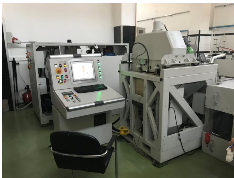
Slika 6. Uređaj za tretman visokim hidrostatskim tlakom (HHP).
