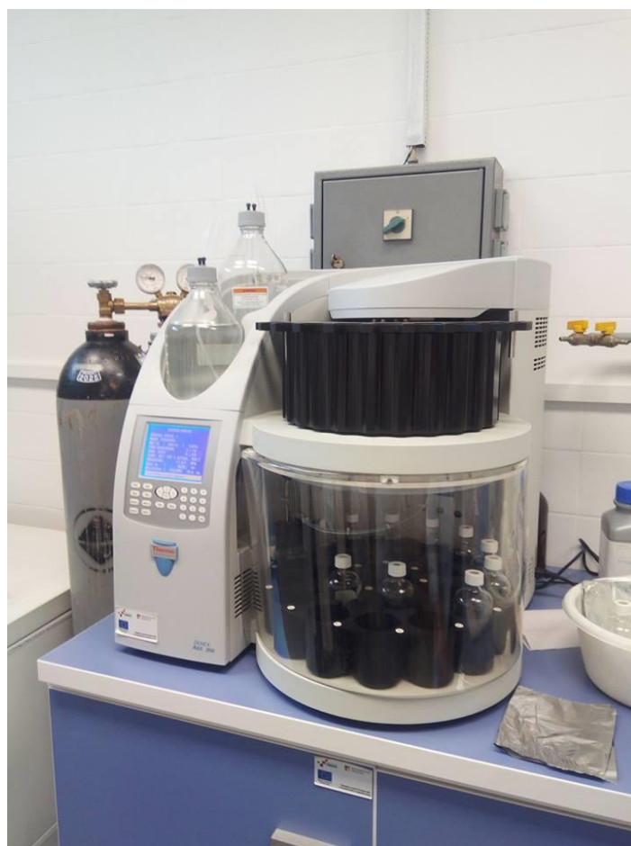
Slika 12. Uređaj za ubrzanu ekstrakciju otapalima, Dionex PLE ® 350 (vlastita fotografija)
