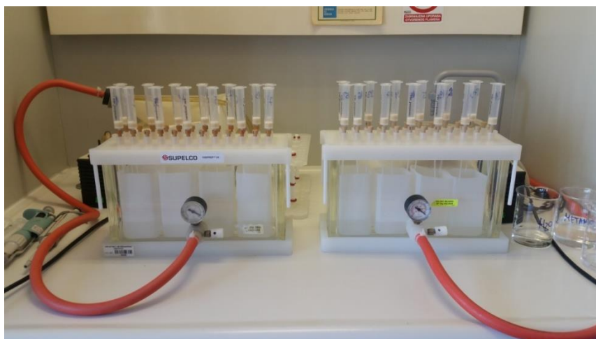
Slika 5. SPE kolone korištene za ekstrakciju aminoglikozida iz mlijeka (vlastita fotografija)
