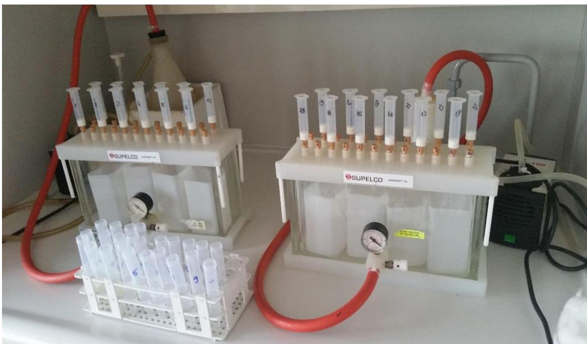
Slika 5. Pročišćavanje uzorka na SPE kolonama Oasis PRiME HLB (vlastita fotografija)
