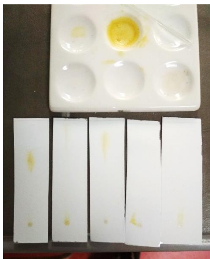
Slika 11. Ispitavanje uzoraka TLC-om za pronalazak prikladnog eluensa
