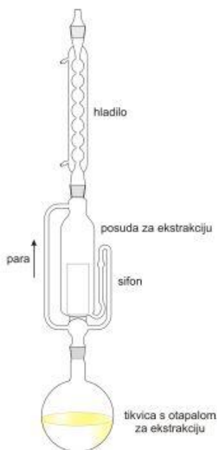
Slika 6. Ekstrakcija po Soxhlet-u
