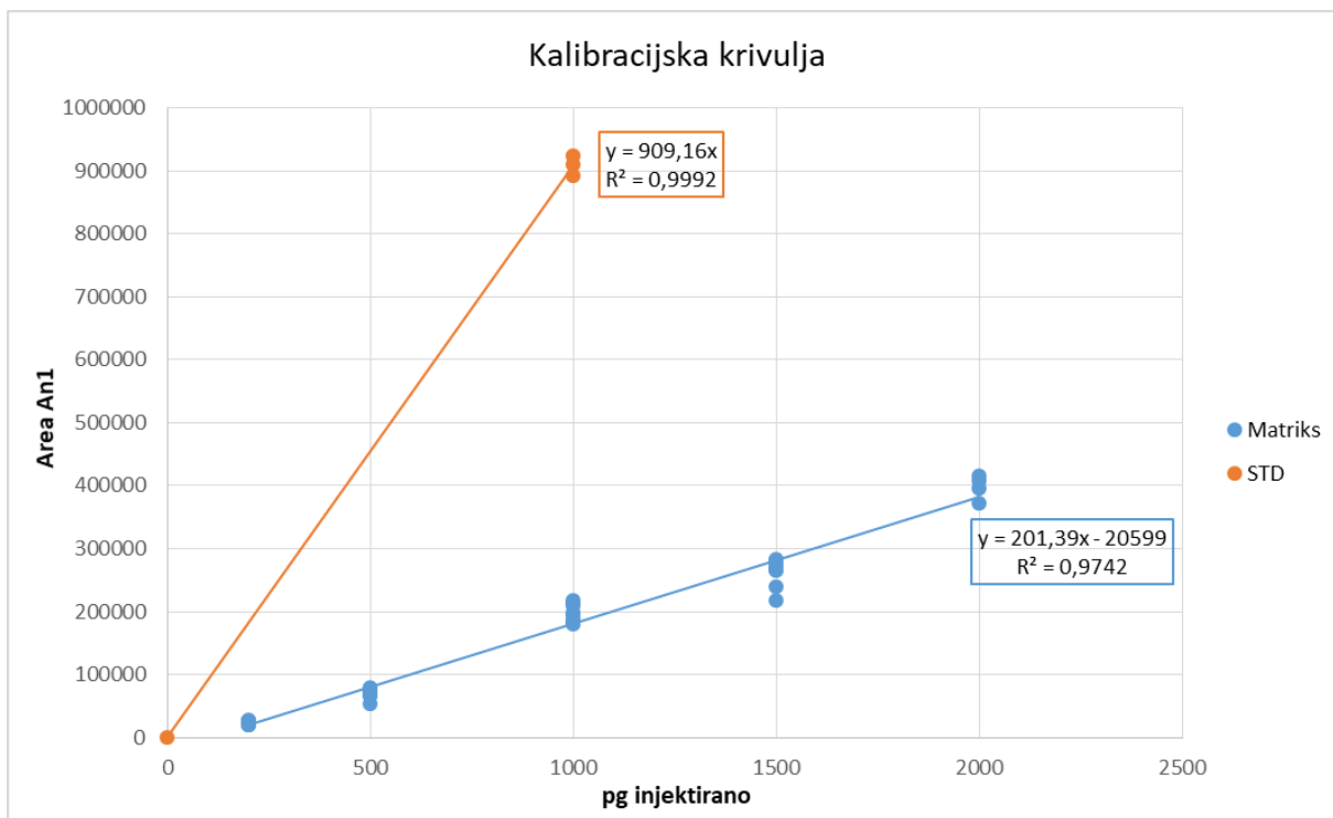
Slika 39. Usporedba standardne (STD) i matriks (Matriks) kalibracijske krivulje za epitetraciklin na UHPLC/Q-TOF-MS uređaju
