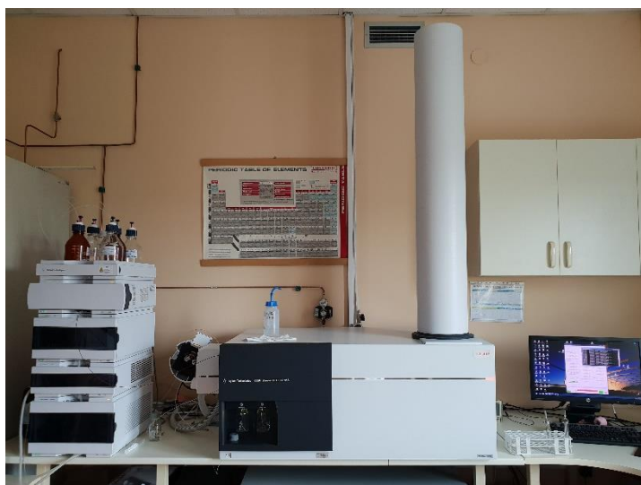
Slika 14. HPLC uređaj 1290 Infinity udružen s masenim analizatorom s vremenom preleta (MS Q-TOF) Agilent 6550 Quadrupole Time of Flight Mass Spectrometer (vlastita fotografija)
