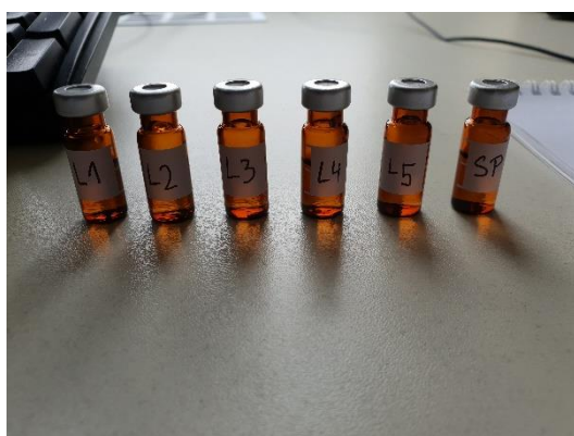
Slika 10. Viale s otopinama za pripremu standardne krivulje na otapalu (vlastita fotografija)
