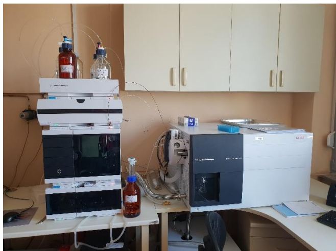
Slika 13. Uređaj HPLC Agilent Technologies 1290 i Triple Quad LC/MS 6470 (vlastita fotografija)
