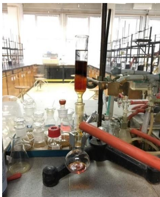
Slika 20. Kromatografska kolona na stupcu od silikagela pri pročišćavanju purinskih derivata
