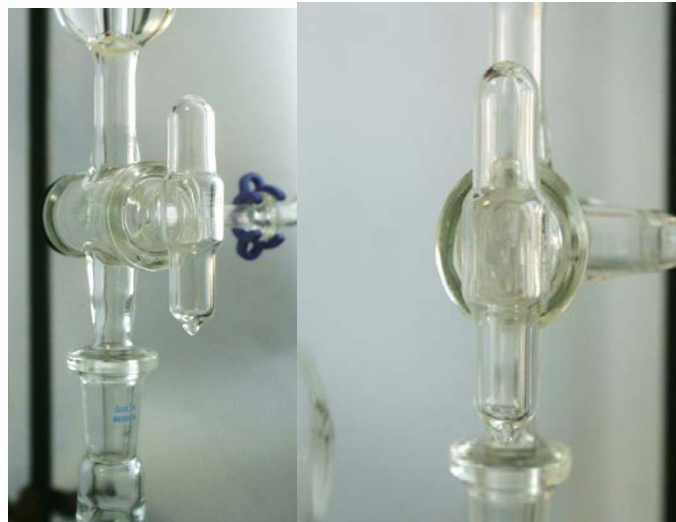
Slika 9. Trokraki vakuumski ventil- pozicija 2
