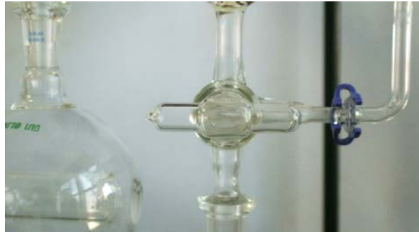
Slika 8. Trokraki vakuumski ventil- pozicija 1
