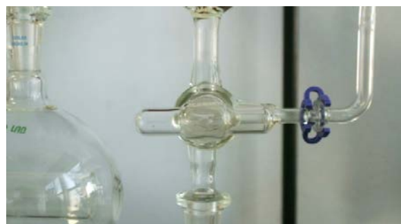
Slika 10. Trokraki vakuumski ventil- pozicija 3
