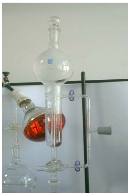
Slika 7. Generator pare i sustav za dušik
