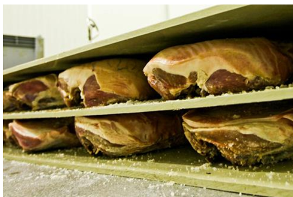
Slika 4. Prešanje butova u proizvodnji Dalmatinskog pršuta (Anonymous, 2014)
