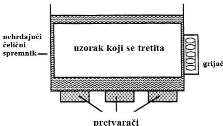
*Slika 5. Ultrazvučna kupelj (Gogate i sur., 2006)*
