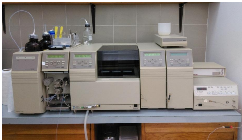
Slika 7. Sustav za tekućinsku kromatografiju visoke učinkovitosti (HPLC).
