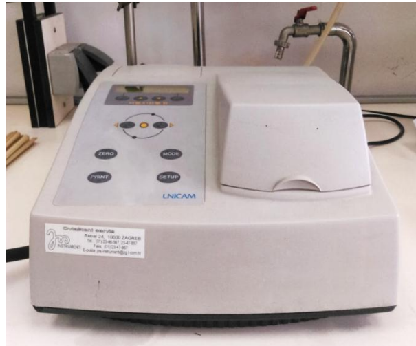
Slika 5. Spektrofotometar Helios Epsilon (Thermo Fischer Scientific, Waltham, Massachusetts, SAD), koji je korišten za određivanje optičke gustoće suspenzije ( OD ) pri valnoj duljini svjetlosti ( \lambda ) od 608 nm.
