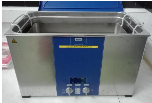
Slika 6. Ultrazvučna kupelj Elmasonic P 300 H (Elma, Singen, Njemačka). Ova je ultrazvučna kupelj korištena u eksperimentima onako kako je to opisano u poglavlju 3.2.5.1.
