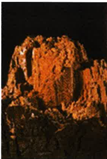
Slika 4. Rezultat djelovanja gljive Formitopsis pinicola (degradirano drvo)
