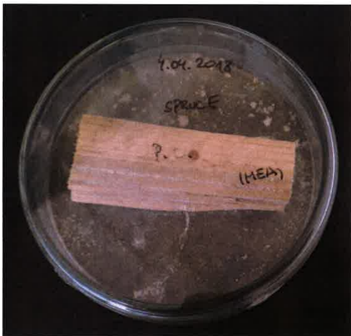
Slika 6. P. chrysosporium porasla na ostacima drveta smreke
