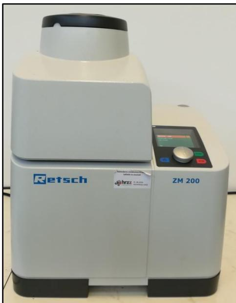
Slika 4. Ultra-centrifugalni mlin (vlastita fotografija).
