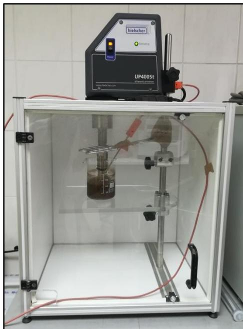
Slika 6. Ultrazvučni procesor, ultrazvučna sonda, temperaturna sonda za vrijeme tretmana heljdinih ljudskica u 10 % vodenoj suspenziji u izolacijskoj komori (vlastita fotografija).
