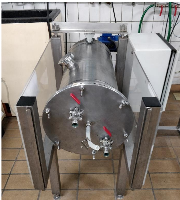
Slika 2. Horizontalni rotirajući cijevni bioreaktor (HRCB).
