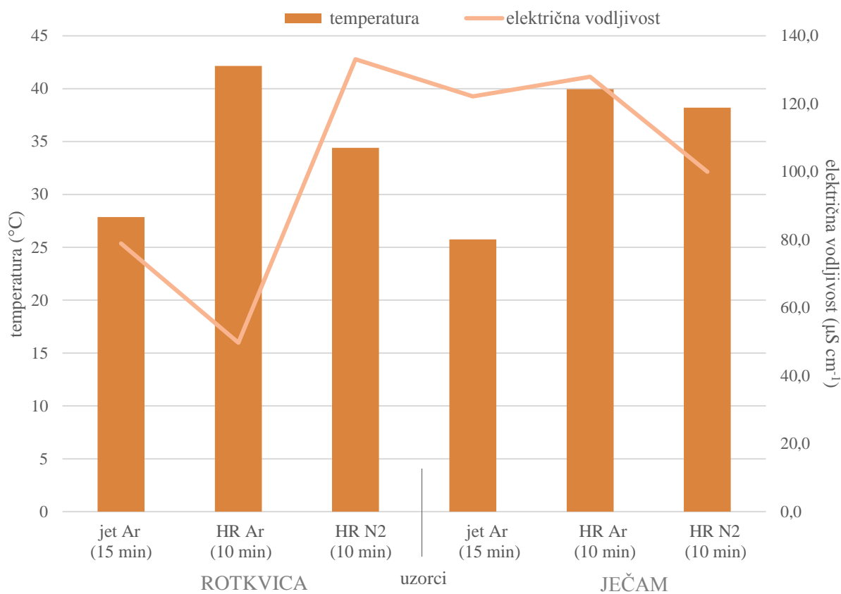
Slika 17. Prikaz vrijednosti temperature i električne vodljivosti PAW vode u ovisnosti o vrsti tretmana hladnom plazmom i tretiranom uzorku
