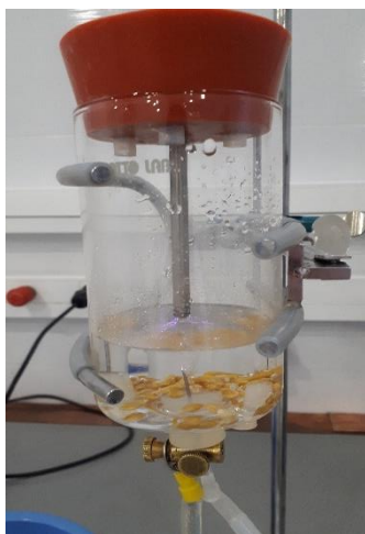
Slika 10. Hibridni plazma reaktor ( vlastita fotografija )
