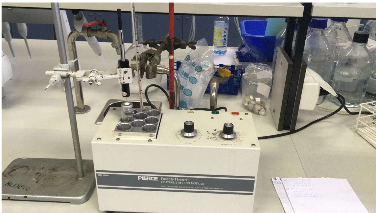
Slika 8. HS-SPME ekstrakcija (vlastita fotografija)
