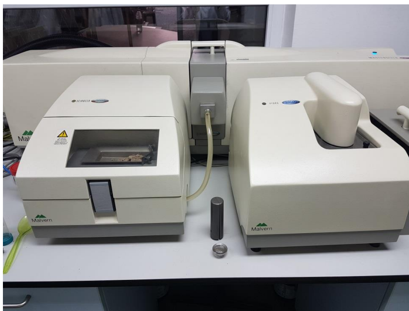
Slika 5. Uređaj za mjerenje veličine čestica (Kuraica, 2019)
