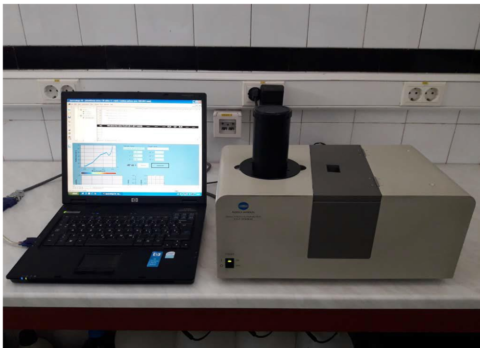
Slika 11. CM-3500d kolorimetar (Konica – Minolta, Japan) (vlastita fotografija)
