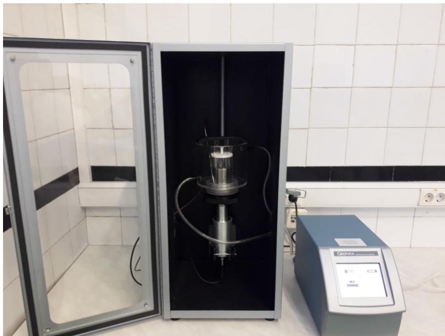
Slika 9. Sustav s direktno uronjenom sondom (vlastita fotografija)
