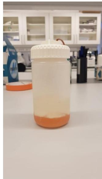
Slika 7. Prikaz odjeljenih faza uzorka nakon miksanja i lipidne ekstrakcije (vodeno/metanolna, protein i lipidno/kloroformna faza) (vlastita fotografija)
