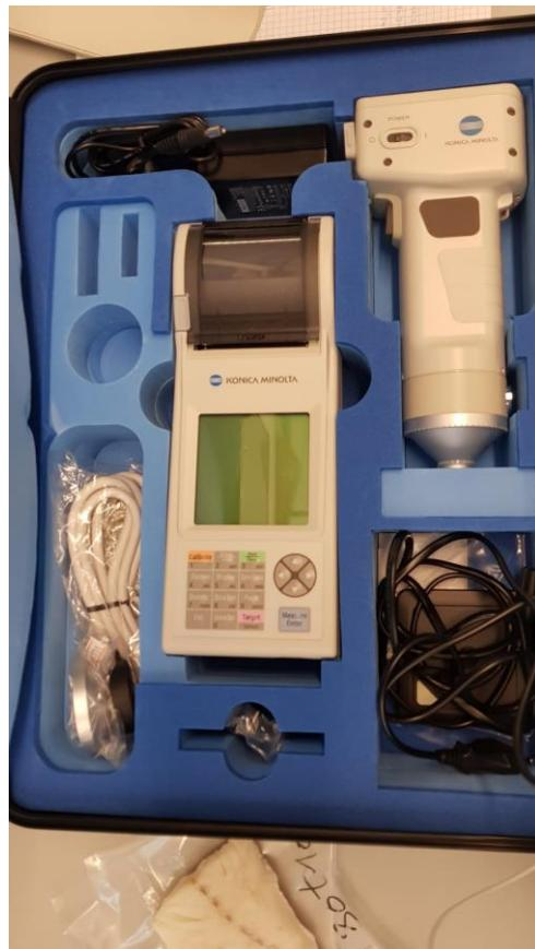
Slika 6. Kolorimetar, Konica-Minolta, Japan (vlastita fotografija)
