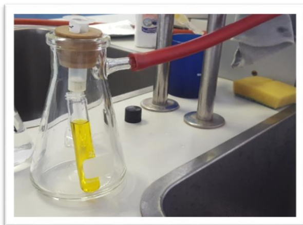
Slika 11. Uklanjanje pigmenata pomoću kolone (Vlastita fotografija)
