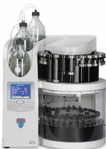
Slika 8. Sustav za ubranu ekstrakciju otapalima pri povišenom tlaku (Dionex ASE 350) (Yang i sur., 2014)
