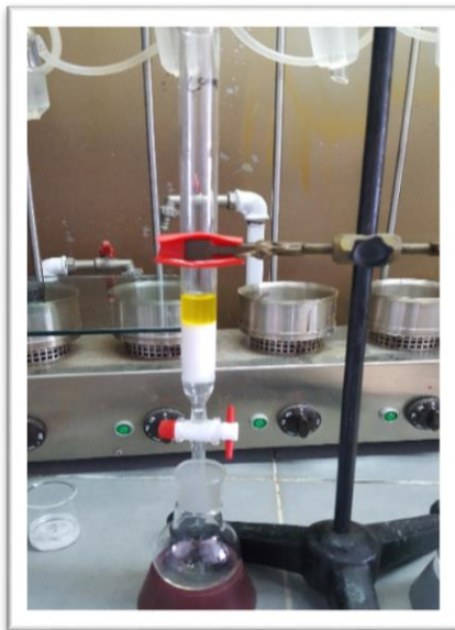
Slika 15. Ekstrakcija neosapunjive frakcije (Vlastita fotografija)
