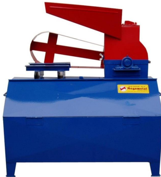
Slika 9. Mlin čekičar tip NA45.
