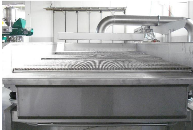
Slika 13. Prikaz vibracijskog stola (Anonymous 9, 2018)
