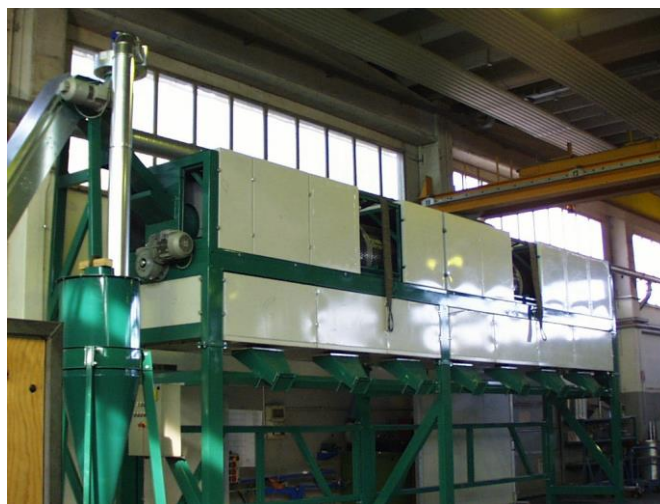
Slika 8. Prikaz uređaja za kalibriranje (Anonymous 5, 2018)
