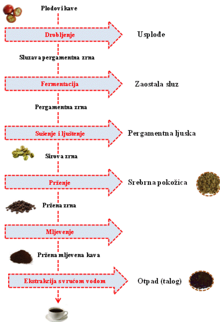
Slika 2. Proizvodnja kave mokrim načinom prema Martinez-Saeza i Castillo (2018).
