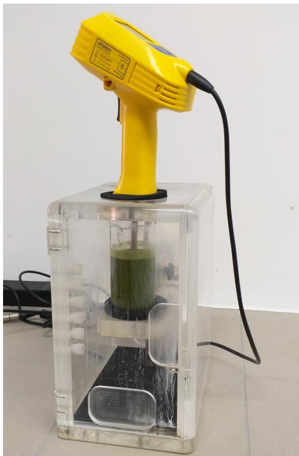
Slika 10. Ekstrakcija potpomognuta ultrazvukom (vlastita fotografija)
