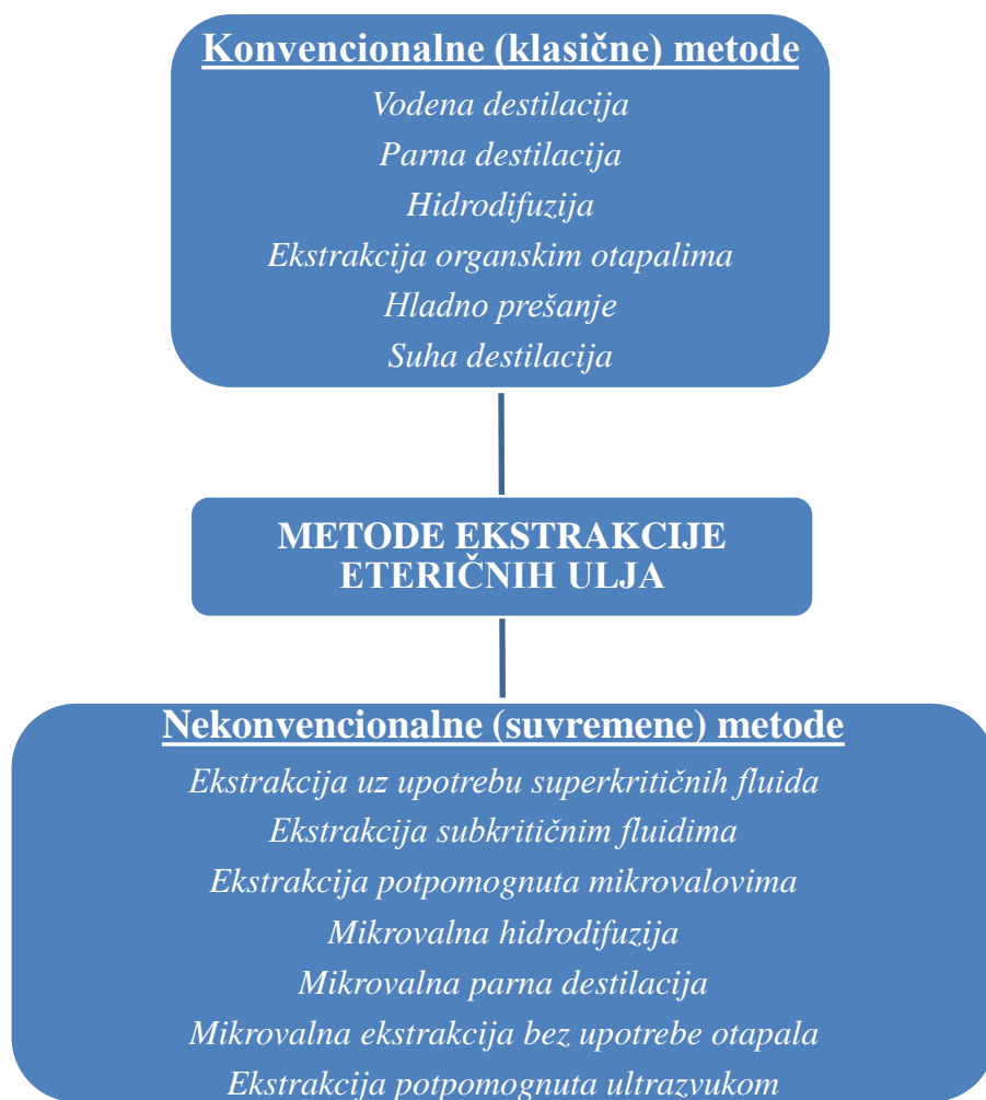
Slika 3. Metode ekstrakcije eteričnih ulja (Dima i Dima, 2015)
