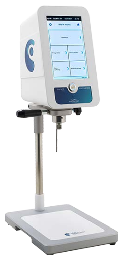
Slika 4. Rotacijski reometar „Viscometer RM 100 plus“ (Anonymous 2)
