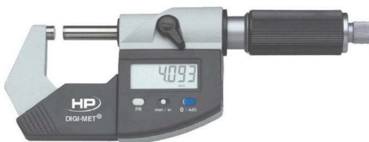
Slika 5. Helios Preisser, mikrometar s digitalnim zaslonom (Anonymous 3)
