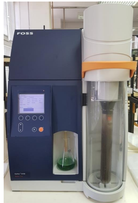
Slika 15. Foss Kjeltac 8100 sustav za destilaciju (vlastita fotografija)
