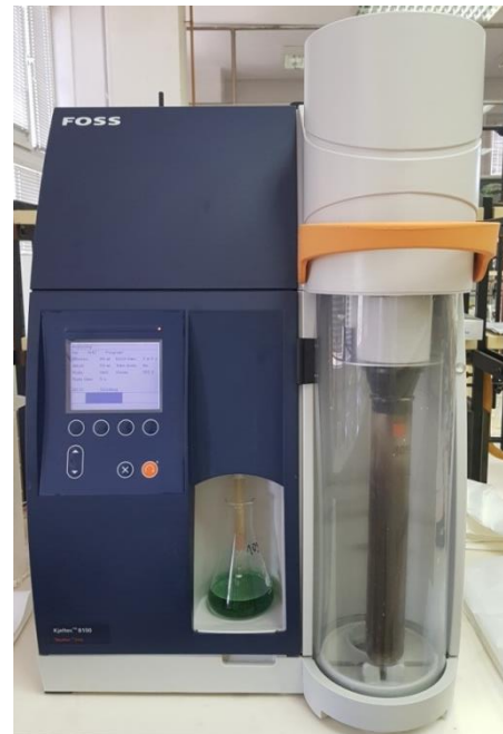
Slika 15. Foss Kjeltac 8100 sustav za destilaciju (vlastita fotografija)
