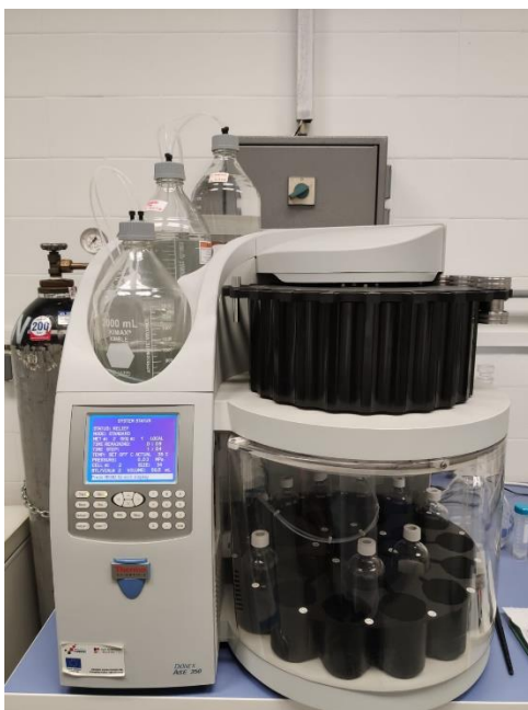
Slika 9. Uređaj za ubrzanu ekstrakciju otapalima pri povišenom tlaku Dionex (model ASE 350®) (vlastita fotografija)
