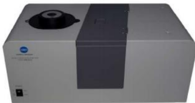
Slika 13. Kolorimetar CM3500d (Konica Minolta, Japan) (Anonymus 7, 2020)
