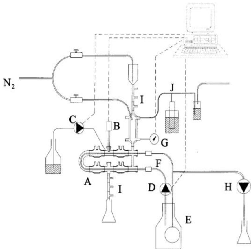
A- jedinice za miješanje, B- pH elektroda, C- alkalna pumpa, D- dijalizna pumpa, E- dijalizno svjetlo, F- dijalizni krug sa šupljim vlaknima, G- senzor razine, H- pumpa za apsorpciju vode, I- peristaltička pumpa s ventilom, J- izlaz za plin s bravom za vodu
