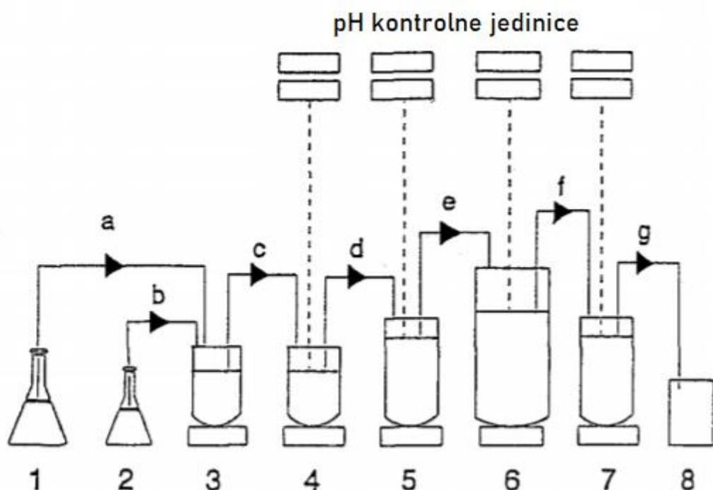
1. prehrana, 2. gušteričin aceton u prahu, 3. reaktor 1 (duodenum i jejunum), 4. reaktor 2 (ileum), 5. reaktor 3 (slijepo crijevo i uzlazno debelo crijevo), 6. reaktor 4 (poprečno debelo crijevo), 7. reaktor 5 (silazno debelo crijevo), 8. otpadni produkti, pumpe a-d radile su polukontinuirano, pumpe e-g radile su kontinuirano
