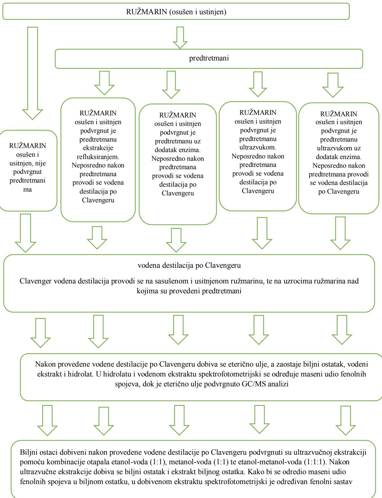
Slika 3. Shematski prikaz postupka provođenja eksperimentalnog dijela
