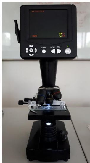
Slika 8. Mikroskop sa digitalnom kamerom za snimanje promjera kapljica u emulziji (vlastita slika)
