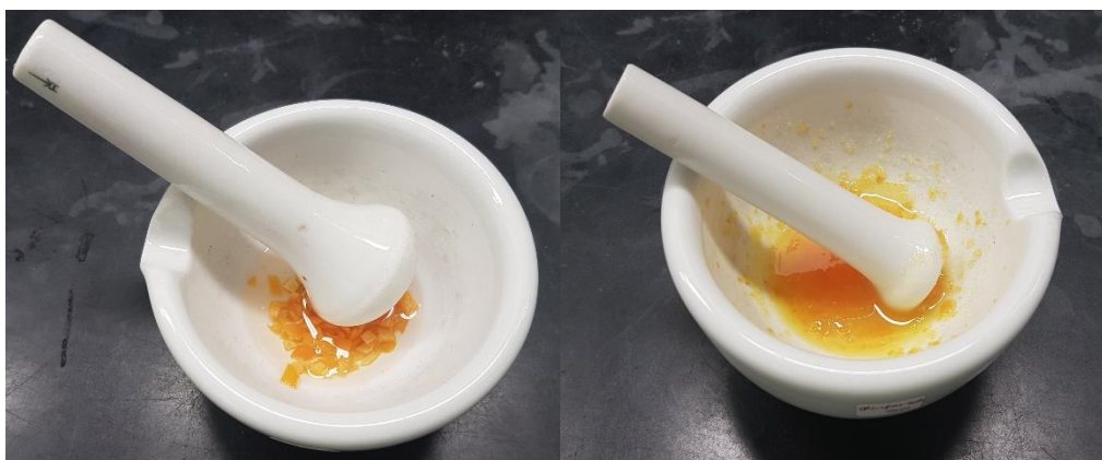
Slika 9. Priprema ekstrakata narančine kore mehaničkom homogenizacijom primjenom tarionika i tučka (vlastita fotografija)
