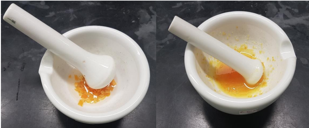
Slika 9. Priprema ekstrakata narančine kore mehaničkom homogenizacijom primjenom tarionika i tučka (vlastita fotografija)
