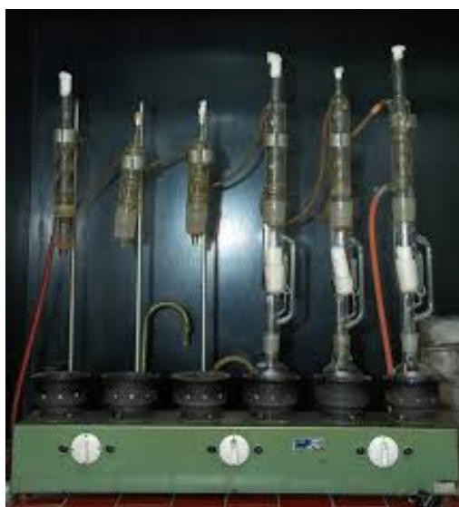
Slika 13. Aparatura za ekstrakciju masti po Soxhletu (Anonymous 7, 2020)
