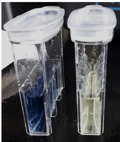
Slika 6. Određivanje ukupnog fosfora – obojenje uzorka i slijepe probe u 50 mm kiveti prije mjerenja na spektrofotometru (vlastita fotografija)
