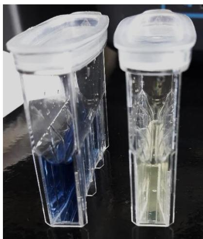
Slika 6. Određivanje ukupnog fosfora – obojenje uzorka i slijepe probe u 50 mm kivetni prije mjerjenja na spektrofotometru (vlastita fotografija)
