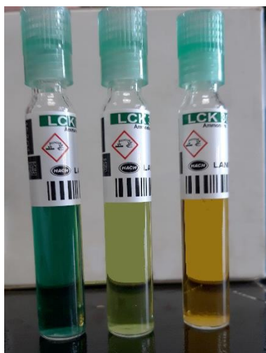
Slika 5. Određivanje amonijevih iona s razvojem obojenja otopine (vlastita fotografija)
