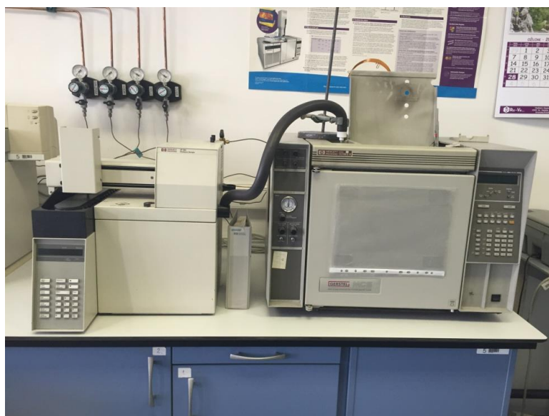
Slika 6. Plinski kromatograf (GC) s plamenoionizacijskim detektorom (FID)-Hewlett-Packard HP 5890 (vlastita fotografija)
