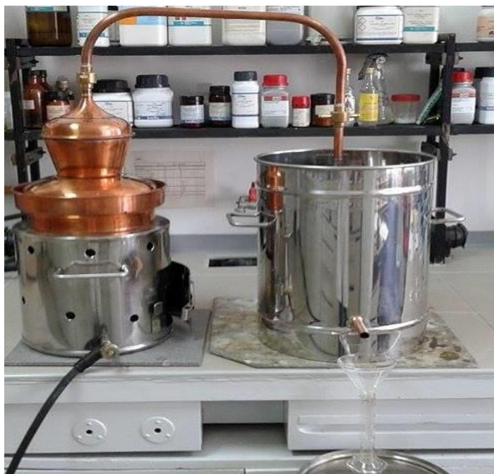
Slika 5. Šaržni laboratorijski kotao za destilaciju (vlastita fotografija)
