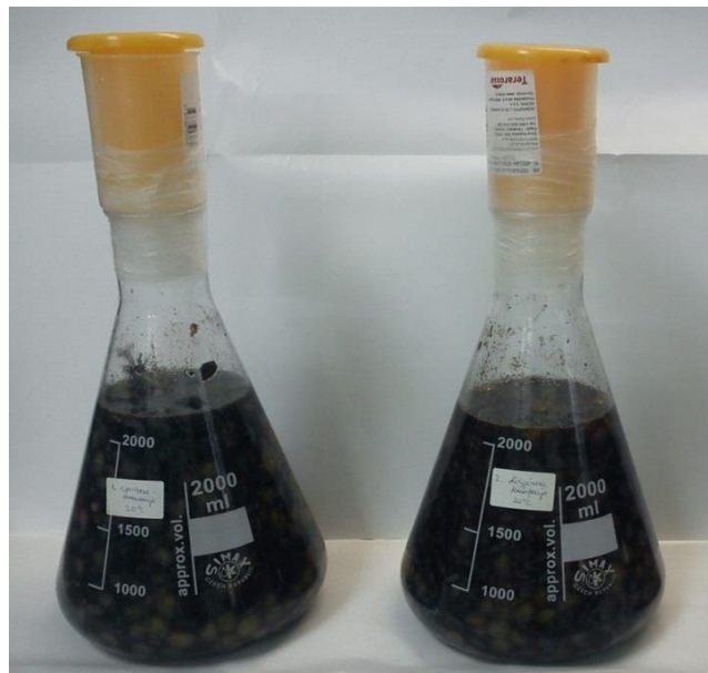
Slika 4. Postavljena alkoholna fermentacija u Erlenmeyerovim tikvicama s vrelnjačom, spontana i dirigirana fermentacija pri 20°C (vlastita fotografija)
