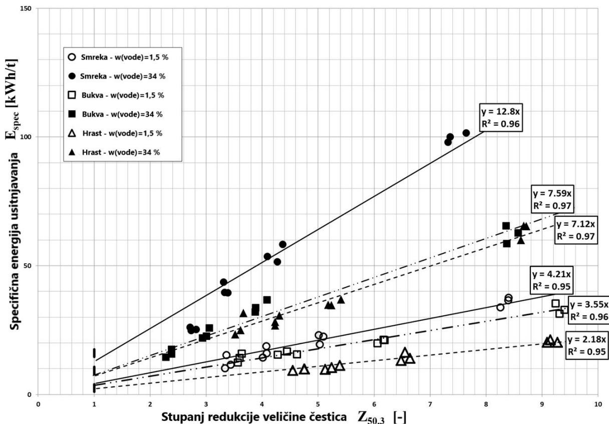
**Slika 12.** Ovisnost specifične energije potrebne za usitnjavanje ( $E_{\text{spec}}$ ) o stupnju redukcije veličine čestica ( $Z_{50,3}$ ) za rezni mlin (Eisenlauer i Teipel, 2020).
