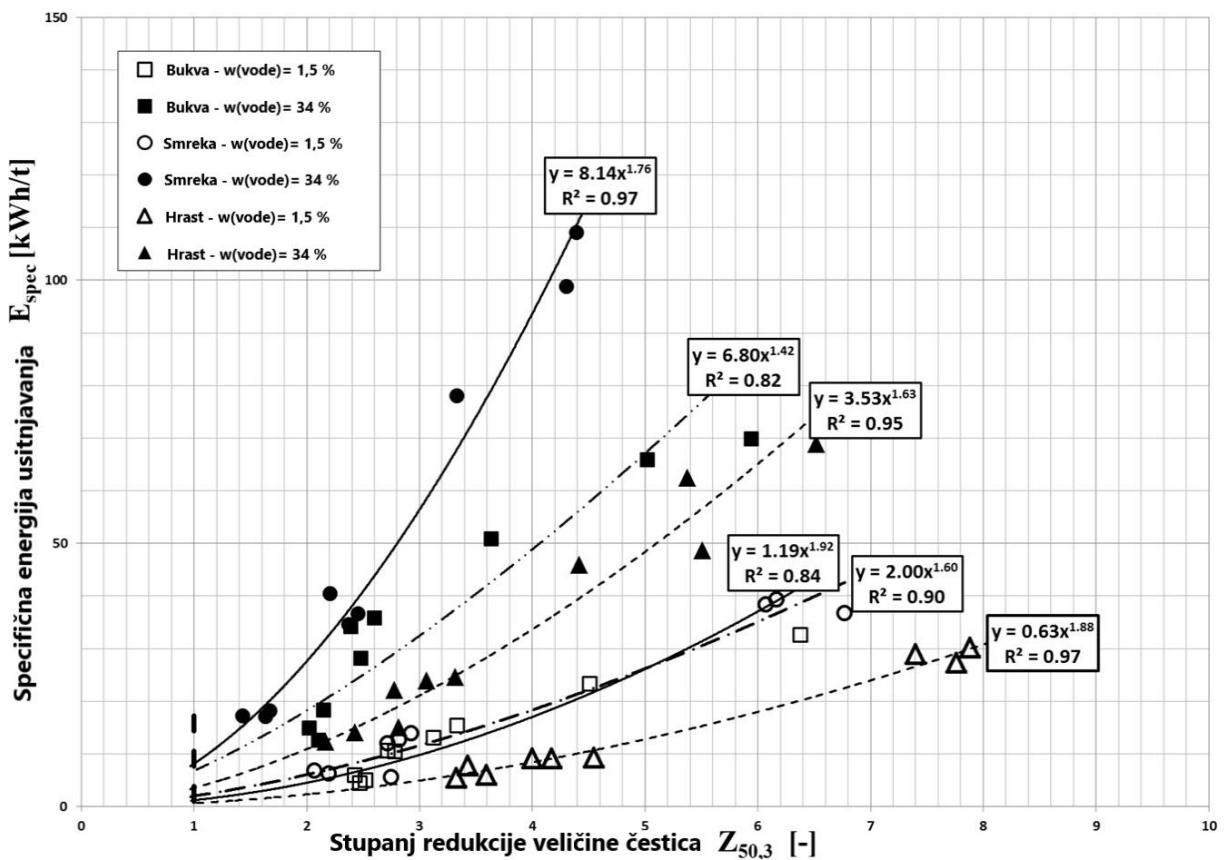
**Slika 13.** Ovisnost specifične energije potrebne za usitnjavanje ( $E_{\text{spec}}$ ) o stupnju redukcije veličine čestica ( $Z_{50,3}$ ) za mlin čekićar (Eisenlauer i Teipel, 2020).
