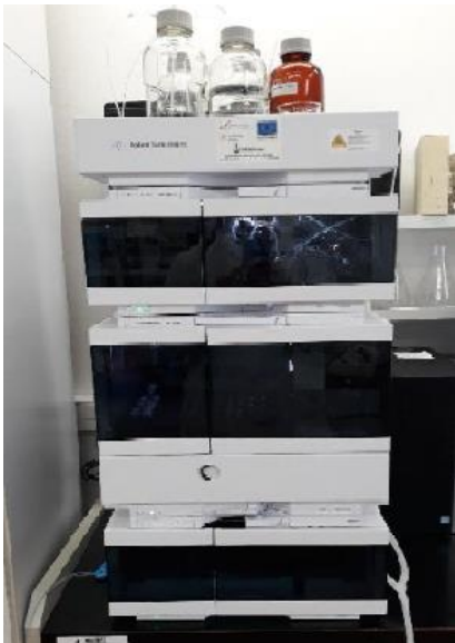
Slika 1. Uređaj „UPLC Agilent Technologies 1290 Infinity II“
