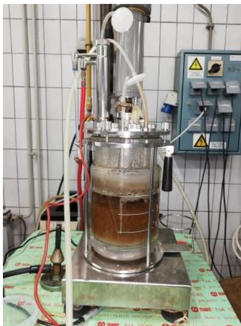
Slika 4. Bioreaktor s mješalom (B. Braun Biotech International, Berlin, Njemačka).
