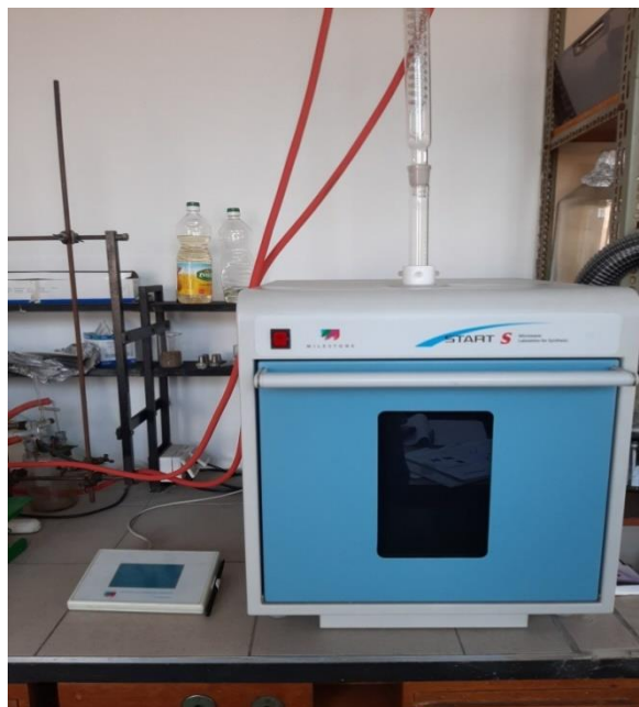
Slika 15. Mikrovalni reaktor Milestone Start S
