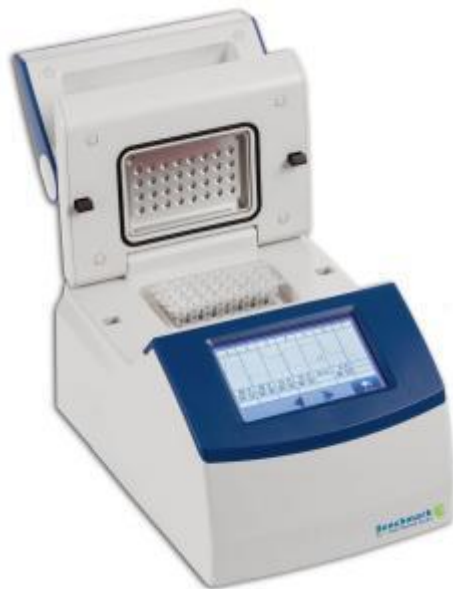
Slika 3. Thermocycler. Prikazan je uređaj za PCR u koji su umetnute 32 tubice s reakcijskom otopinom (nextdayscience.com).
