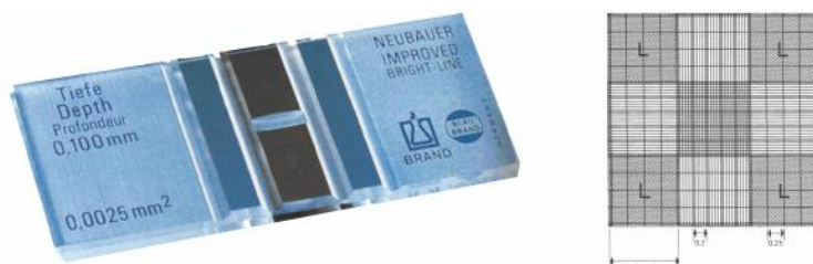
Slika 2. Neubauerova komorica za brojanje stanica (Anonymus 1, 2020).
